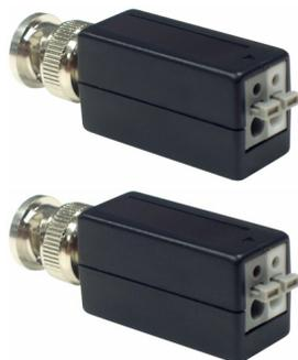
Es capaz de recibir y transmitir señales de video sobre cable UTP , y enviarlo a una distancia máxima de 305m. Dispositivo de protección transitorio. Utiliza cableado de par trenzado, proporcionando un sistema de reducción de ruido.
