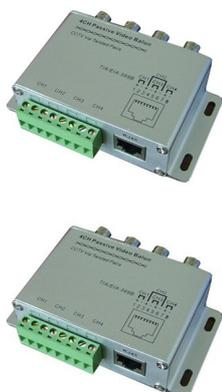
Dispositivo pasivo que permite la transmisión de la señal video en tiempo real vía cable pareado sin blindaje. Se conecta por regleta o conexión de red RJ45. Llega a 330m con elementos pasivos y a 1500m con elementos activos.
