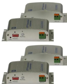
Es un transceptor de activo. Se utilizan para transmitir la señal de vídeo desde cámaras de circuito cerrado de televisión con cable UTP. Lega hasta 1500m con un receptor activo y hasta 300m. Debe utilizar este producto con el balun de recepción.
