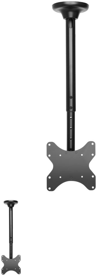
Soporte para LCD inclinable para COLGAR DEL TECHO. · Para pantallas LCD de 23" hasta 42" y 50 kgs. · Giratorio 360° e inclinable desde -25° a 0°. · Ajustable altura desde 560 mm a 910 mm. · Ajuste de nivel de pantalla de -3° a +3°. · VESA 100x100, 200x100 y 200x200. · Color: Negro.
