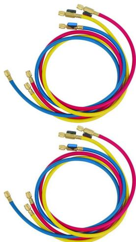
DS60800 Juego 3 Mangueras de Alta Presion para R410A. Presión de trabajo 800psi, Rotura 4000psi. Medida: 1500mm. ROJO (alta presión), AZUL (baja presión) y AMARILLO (carga o vacio). Junta de TEFLON o de Nitrilo HNBR. Medidas: 1/4" - 5/16" (codo)
