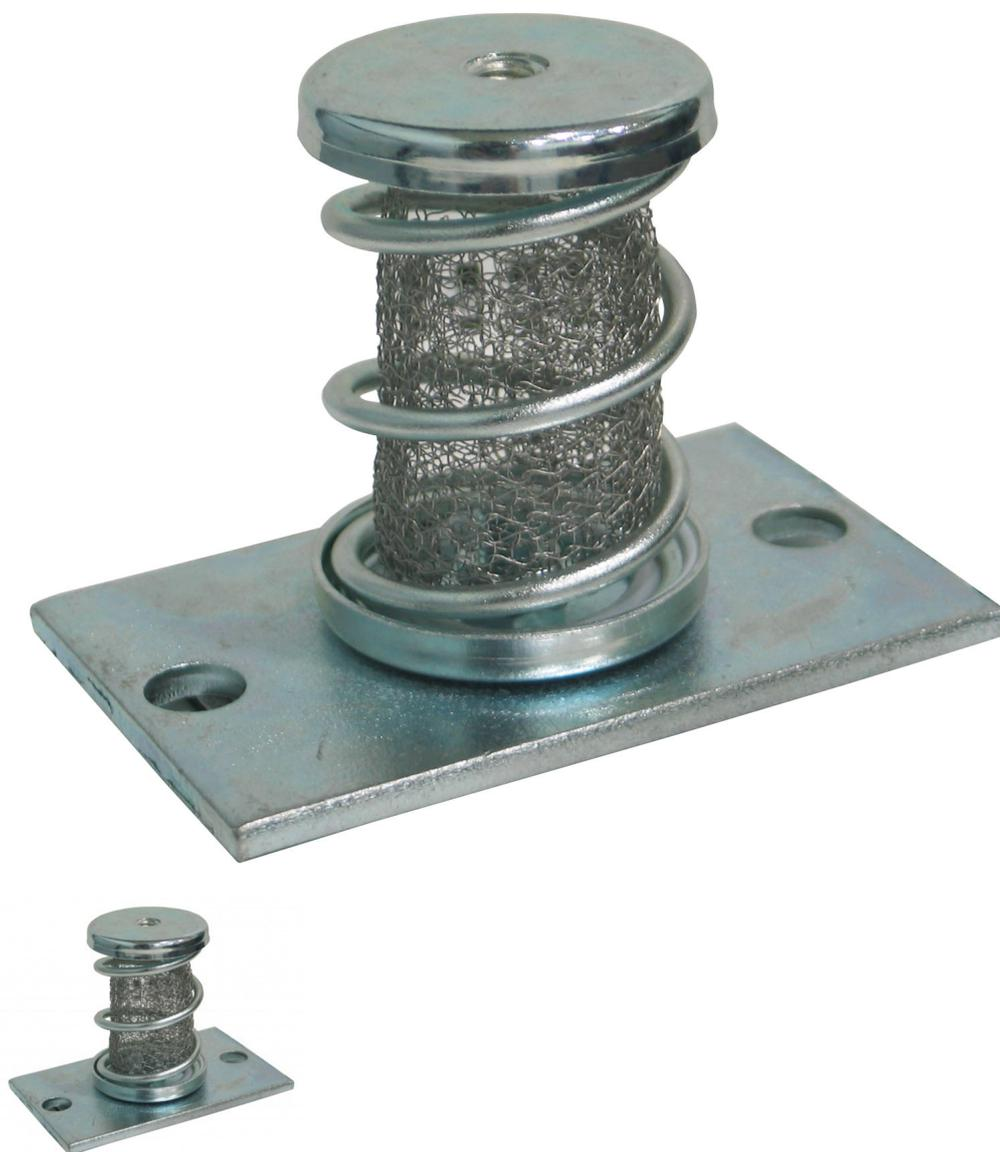
Aisladores metalicos de muelle de baja frecuencia , gran resistencia a los agentes atmosfericos, indicados para aislar todo tipo de maquinaria con regimen de trabajo de ciclo bajo, apartir de 600 r.p.m.Fabricadas en acero normalizado de alta resistencia y
