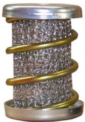
Aisladores metalicos de muelle de baja frecuencia, gran resistencia a los agentes atmosfericos, indicados para aislar todo tipo de maquinaria con regimen de trabajo de ciclo bajo, apartir de 600 r.p.m. Fabricadas en acero normalizado de alta resistencia y tr
